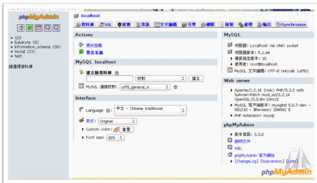
圖一：phpMyAdmin 為一套 PHP 語言編寫而成的軟體，可以使用 Web 介面的按鍵取代繁雜的 SQL 語言來操作 MySQL，使資料庫的管理可以更便利、更有效率。
